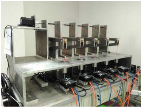
图 13 弹片热-机械疲劳试验 Fig. 13 TMF test of elastic sheet
