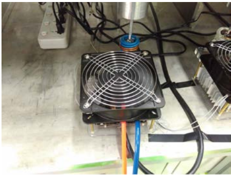
图 14 弹片热-机械疲劳试验加载 Fig. 14 Loading of TMF test for elastic sheet
